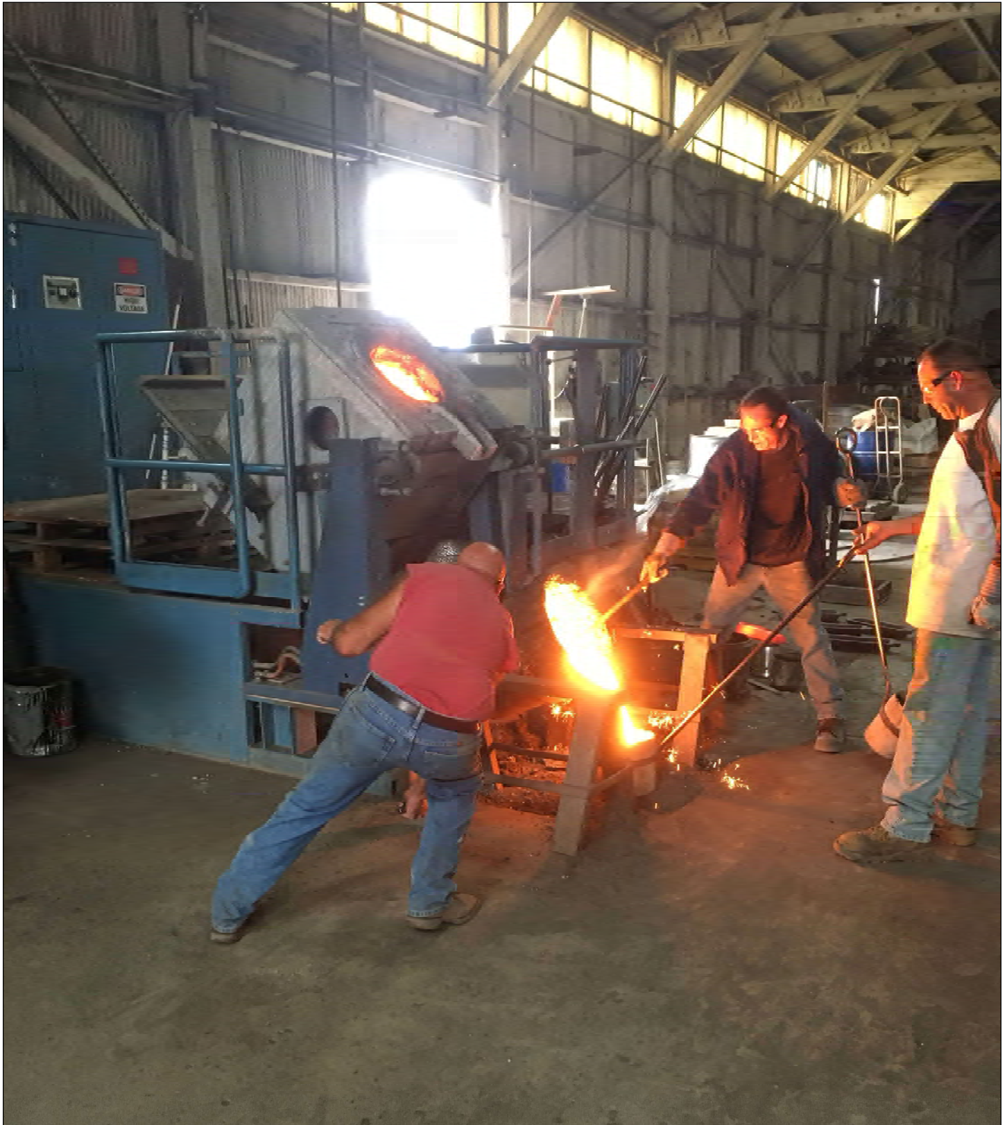
Pouring the molten iron. Photo: Jay T. Shellen
